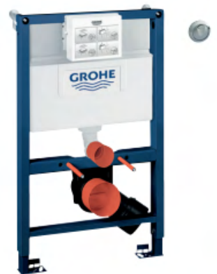
Rapid SL | 82 cm Element til WC, 82 cm installationshøjde med skylle- cisterne GD2 (3/6 liter). Inkl. vægbeslag og Eau2 trykknop.
